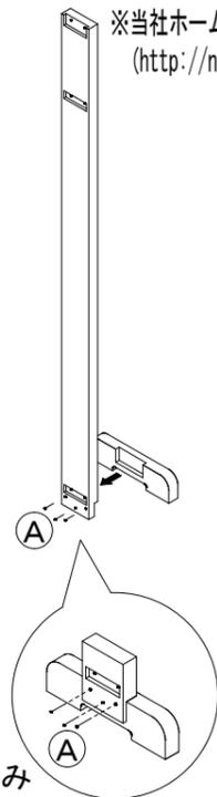
②立枠の溝に中枠・下枠を差し込み
