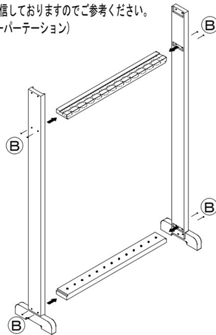
③立枠の溝に上枠をはめ込み
