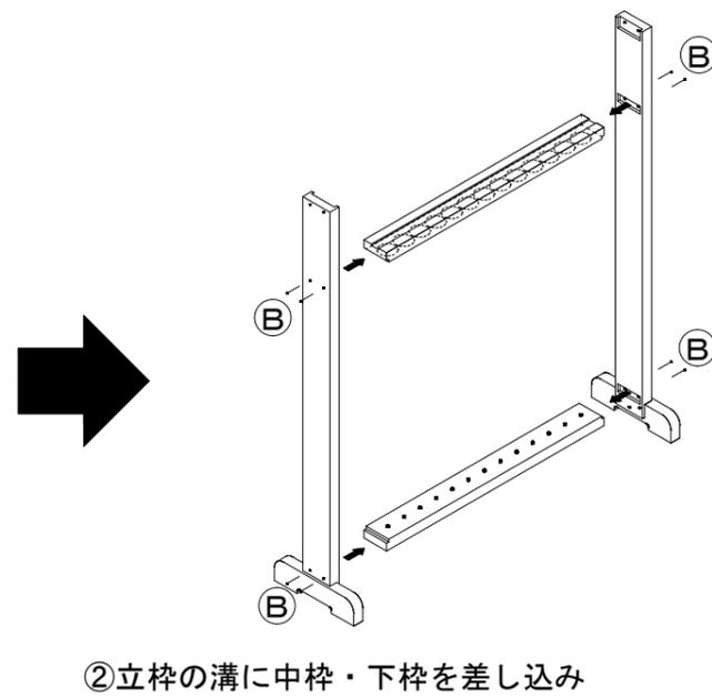
②立枠の溝に中枠・下枠を差し込み
