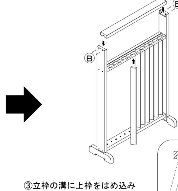
③立枠の溝に上枠をはめ込み
